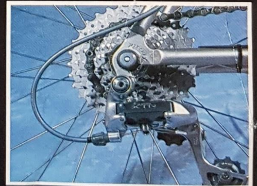
Shimano XTR-Schaltung Ritchey-Ausfallenden
